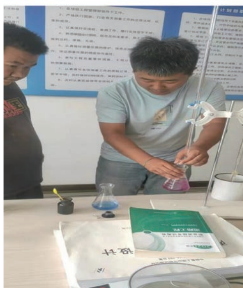
图9 EDTA 测定水泥剂量
