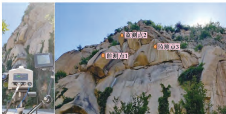
图 12 边坡预警系统和岩体监测
